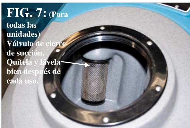
**FIG. 7:** (Para todas las unidades) Válvula de cierre de succión.
