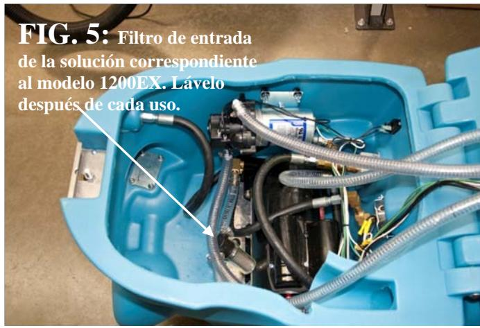
**FIG. 5:** Filtro de entrada de la solución correspondiente al modelo 1200EX. Lávelo después de cada uso.
