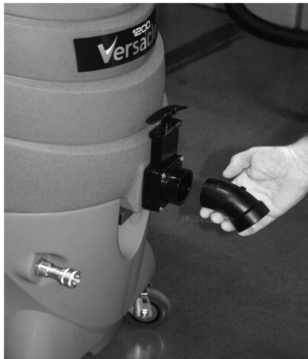
FIG. 7 : Tube d'évacuation du drain par gravité
