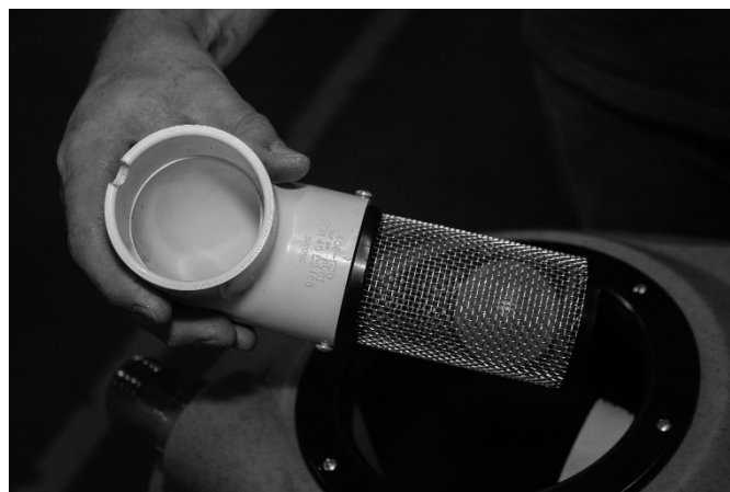
FIG. 5 : Retirer et nettoyer la vanne d'arrêt de l'aspiration
