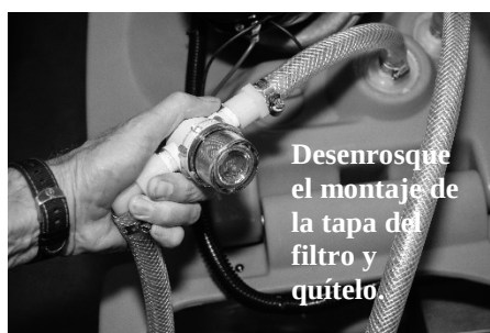
FIG. 4: Limpieza del filtro de entrada de solución
