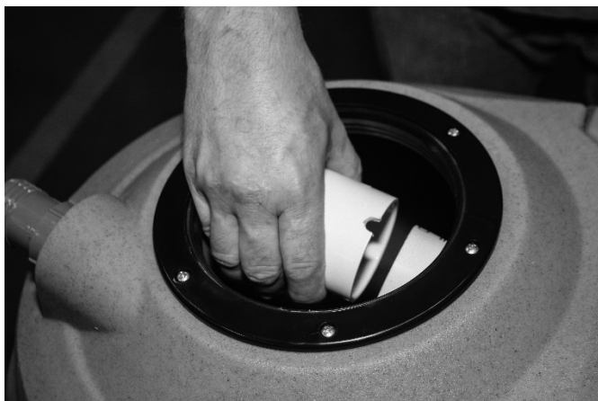
FIG. 5 : Retirer et nettoyer la vanne d'arrêt de l'aspiration
