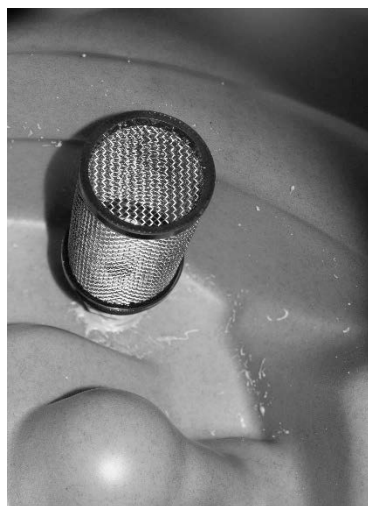
FIG. 6: Prefiltro del tanque de recuperación (sólo modelos c/ bomba de salida)
