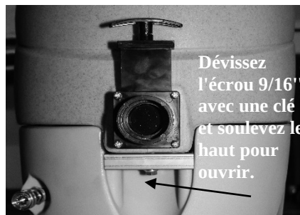
FIG. 4 : Nettoyage du filtre d'aspiration du mélange nettoyant
