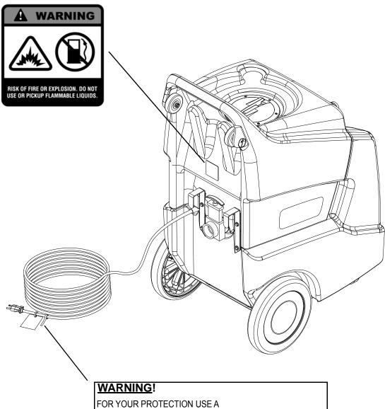
FOR YOUR PROTECTION USE A GROUND FAULT CIRCUIT INTERRUPTER
