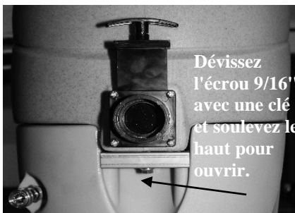
FIG. 4 : Nettoyage du filtre d'aspiration du mélange nettoyant
