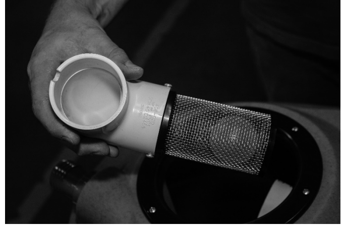
FIG. 5: Extracción y limpieza de la válvula de corte de la aspiradora
