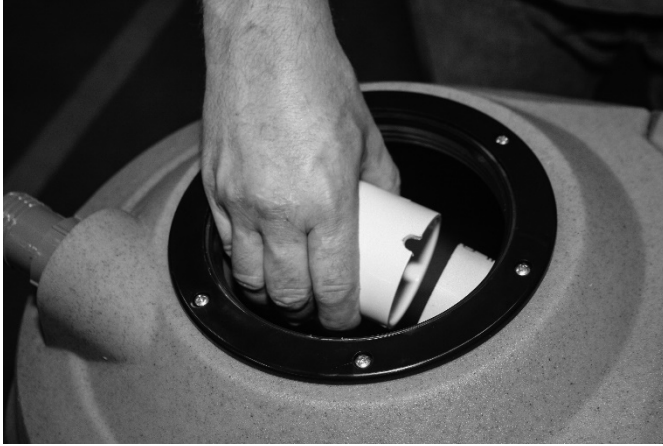
FIG. 5: Extracción y limpieza de la válvula de corte de la aspiradora
