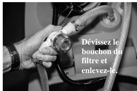
FIG. 4 : Nettoyage du filtre d'aspiration du mélange nettoyant
