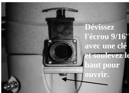
FIG. 4 : Nettoyage du filtre d'aspiration du mélange nettoyant
