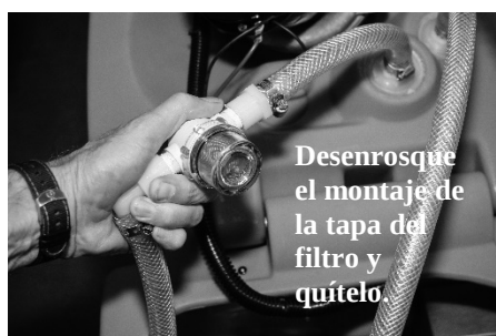
FIG. 4: Limpieza del filtro de entrada de solución
