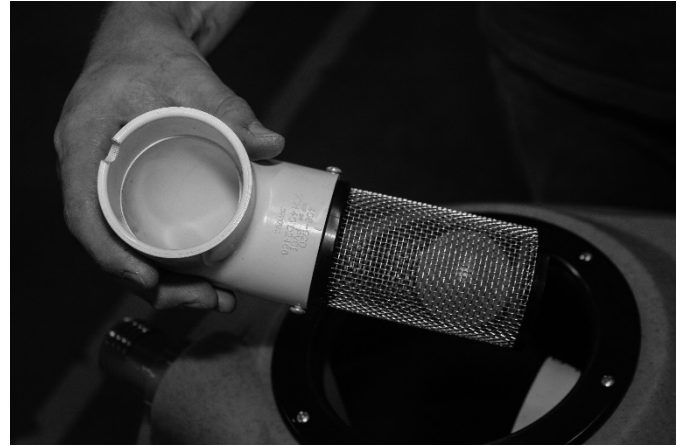
FIG. 5 : Retirer et nettoyer la vanne d'arrêt de l'aspiration
