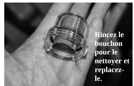
FIG. 4 : Nettoyage du filtre d'aspiration du mélange nettoyant
