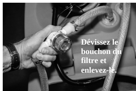
FIG. 4 : Nettoyage du filtre d'aspiration du mélange nettoyant
