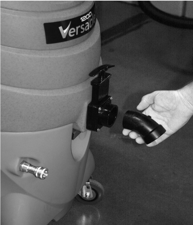
FIG. 7 : Tube d'évacuation du drain par gravité
