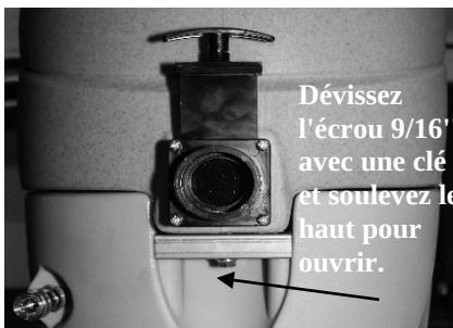
FIG. 4 : Nettoyage du filtre d'aspiration du mélange nettoyant
