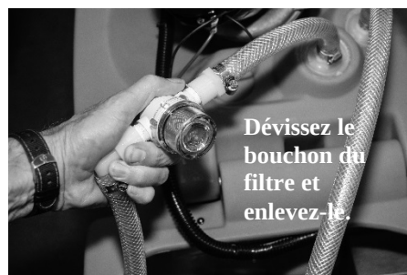
FIG. 4 : Nettoyage du filtre d'aspiration du mélange nettoyant
